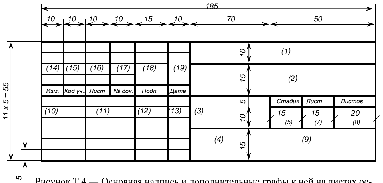
Рисунок Т.4 — Основная надпись и дополнительные графы к ней на листах основного комплекта рабочих чертежей по ГОСТ Р 21.1101, форма 3
