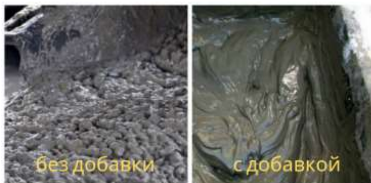
Рисунок 1 – Пример бетона с добавкой и без добавки
