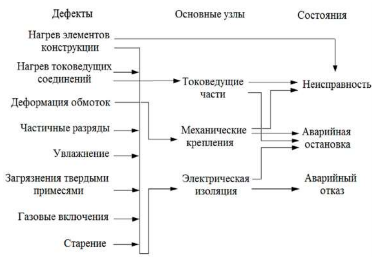
Рисунок 1 – Классификация внутренних повреждений силового трансформатора
