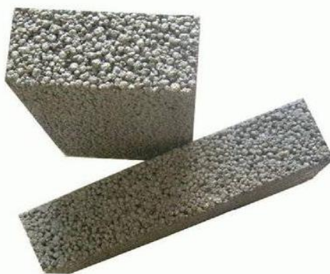
Рисунок 1 - Структура лёгкого бетона на пористых заполнителях
