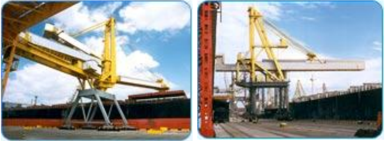
Рисунок 4 - Конвейеры с пространственной трассой
